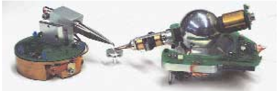
Abbildung 1: Mikromontage mit Hilfe zweier Mikroroboter.
