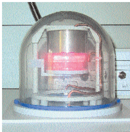
Abbildung 4: Plasma-Sputter-Anlage zur Vorbereitung von Trägern für Biochips
