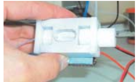
Abbildung 1: Sensoranordnung zur Messung von Sprengstoff-Derivaten in einer Durchflusszelle.
