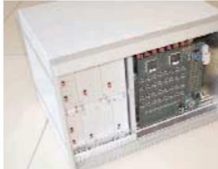
Abbildung 2: DiPhAS II, Digitales Phased Array System (Frontplatte rechts geöffnet).
