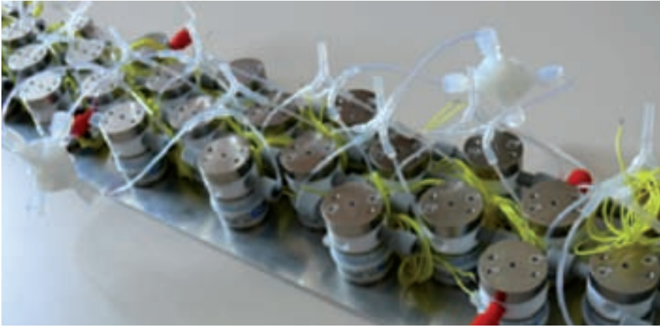
Abbildung 3: Sechszwanzig elektrisch angesteuerte Ventile zum variablen Umschalten des Flusses.
