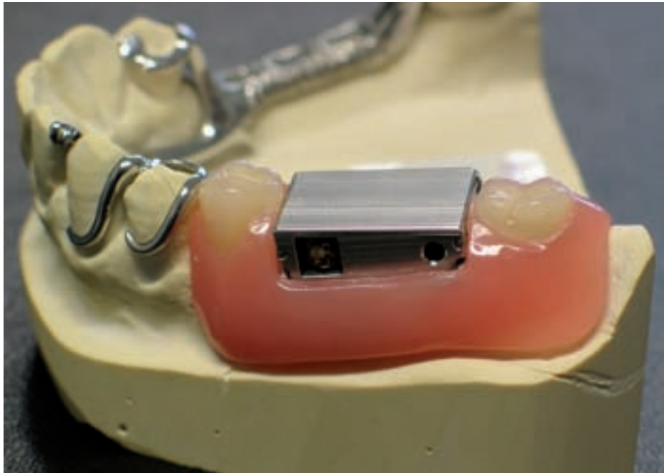
Abbildung 1: Das INTELLIDRUG-Dosiersystem in einer ersten Erprobungsphase. Das spätere Design wird so flach sein, dass es auch bei einem vollständigen Gebiss eingesetzt werden kann.
