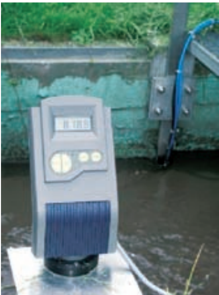
Abbildung 6: Im Vordergrund das Füllstandmesssystem zur Bestimmung der Pegelhöhe, diagonal dahinter (unter Wasser) die an einer Edelstahlschiene montierten Ultraschallsensoren zur Ermittlung der Durchflussmenge.
