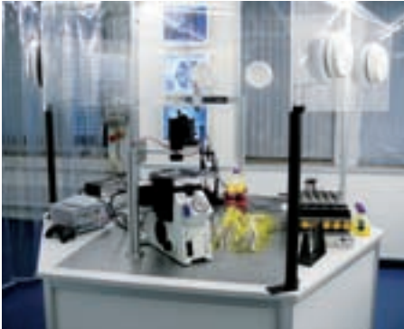
Abbildung 3: Experimentalplatz zur Erprobung der optischen und fluidischen Komponenten des MagLab.
