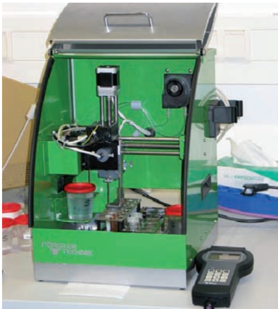
Abbildung 1: Milchprogesteron-Analysator mit faseroptischem Immunsensor (Gemeinschaftsentwicklung Förster Technik GmbH (Engen) und Fraunhofer IBMT).
