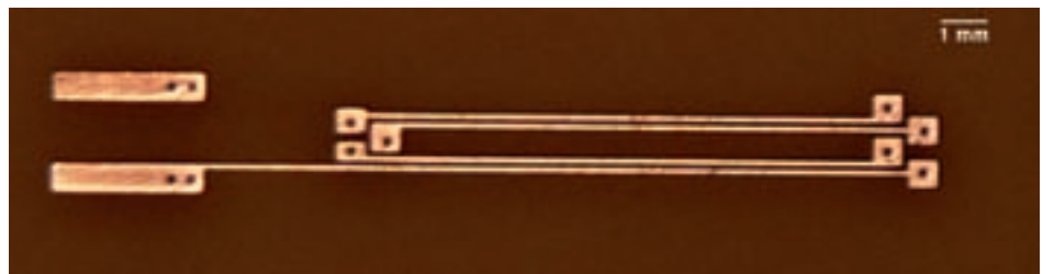
Eine Auswahl von am IBMT entworfenen Mikrospulen zur Integration in die in Abbildung 1 und 2 gezeigten Magnetsysteme. Das Design der Spule kann auf die jeweilige Probe und Anwendung zugeschnitten werden, was zur Verbesserung des Messsignals führt.
