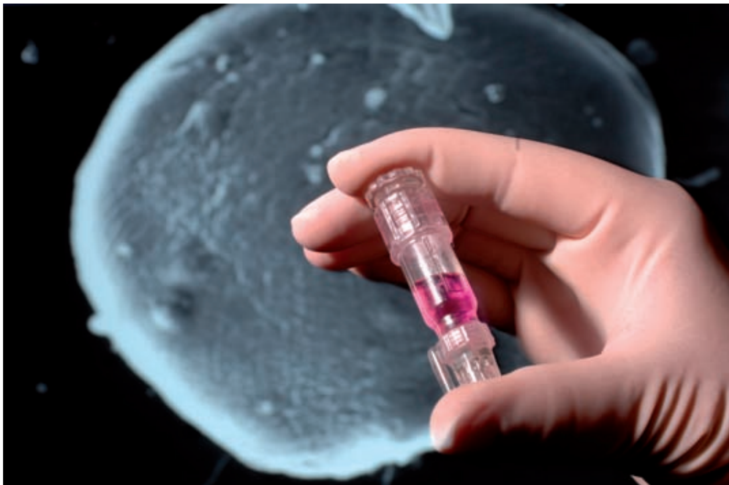
HIV-Kryoröhrchen mit Barcodelabel, RFID, elektronischem Memory Chip (Fraunhofer IBMT-Kryotechnologie).
