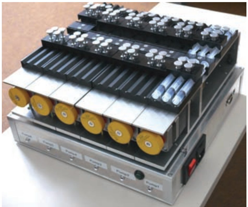
Abbildung 2: Sechskanaliges Spritzenpumpenmodul für die paarweise, einander entgegengesetzte Anordnung von jeweils bis zu sechs Spritzen (Push-Pull-Prinzip).
