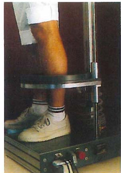
Bild 3: Gesamtaufbau des Ultraschall- Beinvolumen- Meßgerätes
